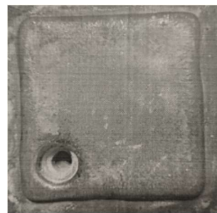
Рисунок 2. Наплавлений шар з отвором від водоохолоджуваного пальця і графітовою заглушкою
