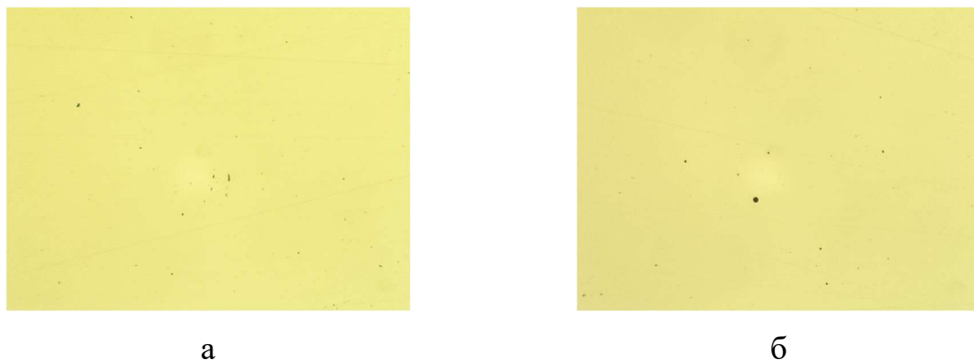
Рисунок 1. Аналіз неметалевих вкраплень ободу залізничного колеса ( \times 100 )
