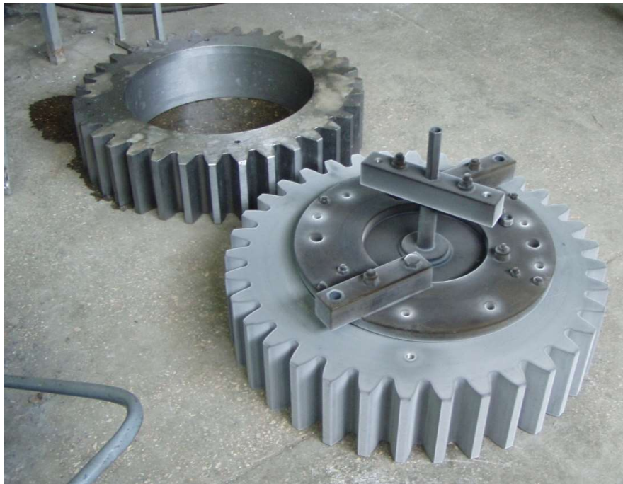
Рис. 3. Зубчасті колеса до і після модифікації БАТР
