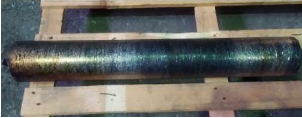
Рис. 2. Зливков Ø 110 мм (сплав 60Zr20Ti20Nb)
