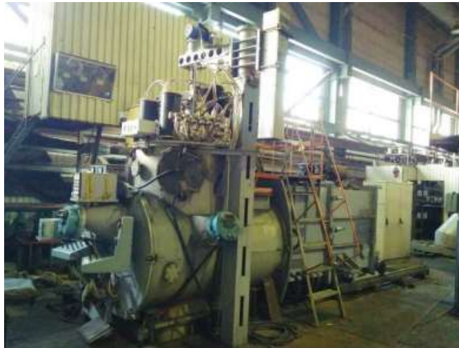
Рис. 1. Зовнішній вигляд модернізованої електронно-променевої установки УЕ-208
