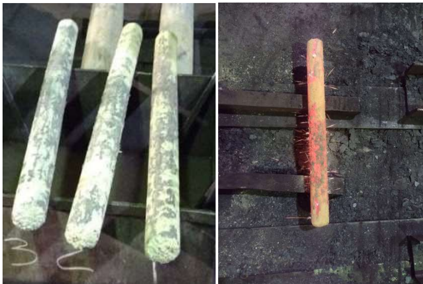
Рис. 2. Охолодження поковки у повітрі (а) та зовнішній вигляд поковок після охолодження (б)
