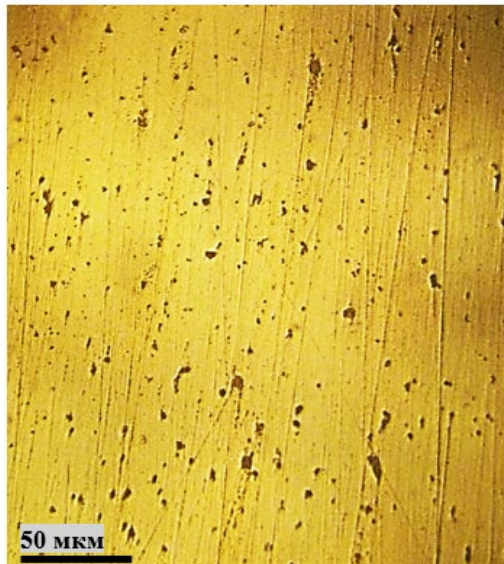
Рис. 4. Вкраплення мікросуспензії у сплаві міді з 4,8 % карбонільного заліза, перегрітому на 120 К над лінією ліквідус (травлено)
