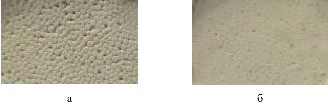
Рис. 1. Пінополістиролова модель зразків із щільністю: а – 0,017 г/см 3 ; б – 0,024 г/см 3
