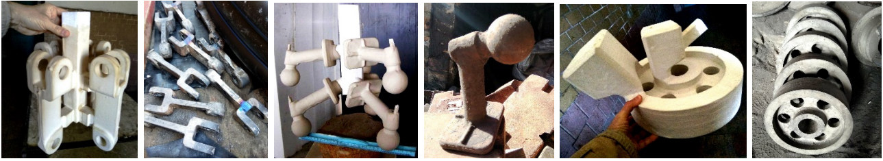
Рис. 4. Моделі і виливки ланок конвеєра та інших деталей механізмів
