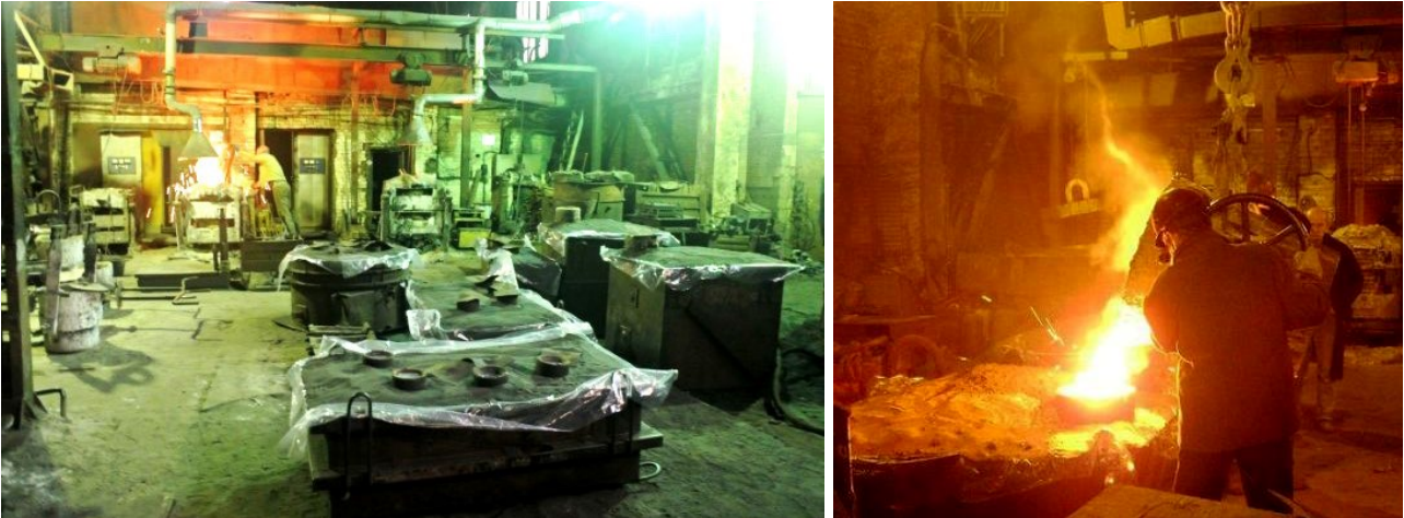
Рис. 2. Піщані форми різних розмірів в цеху ЛГМ та заливання їх металом
