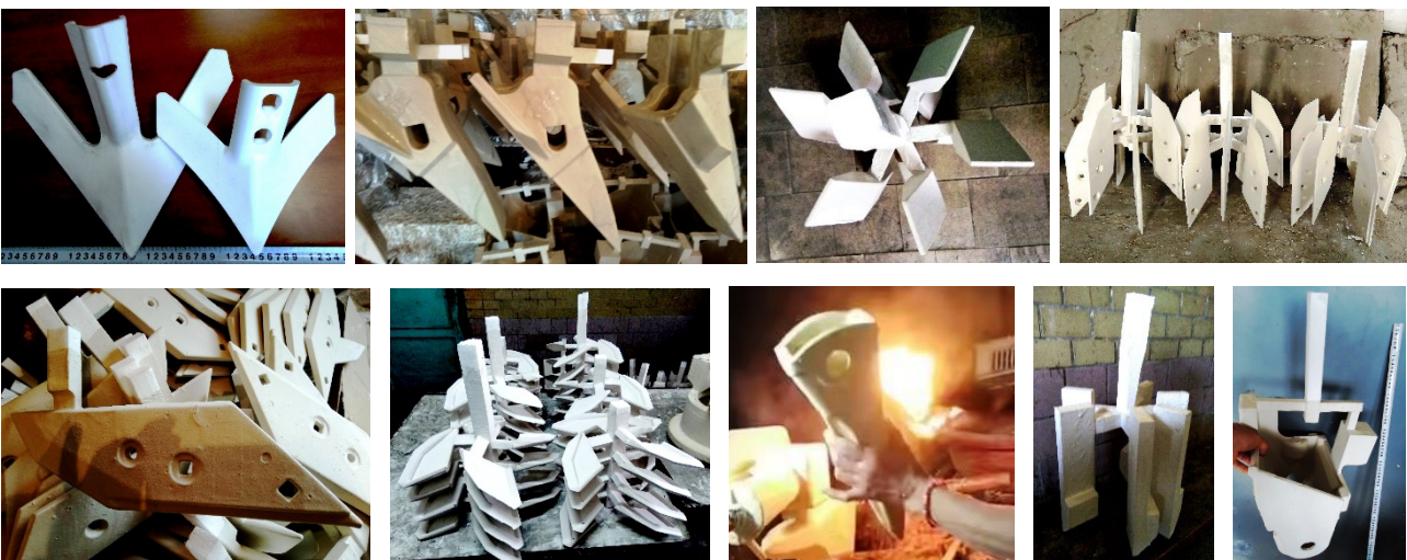
Рис. 3. Приклади ливарних моделей деталей навісного обладнання
