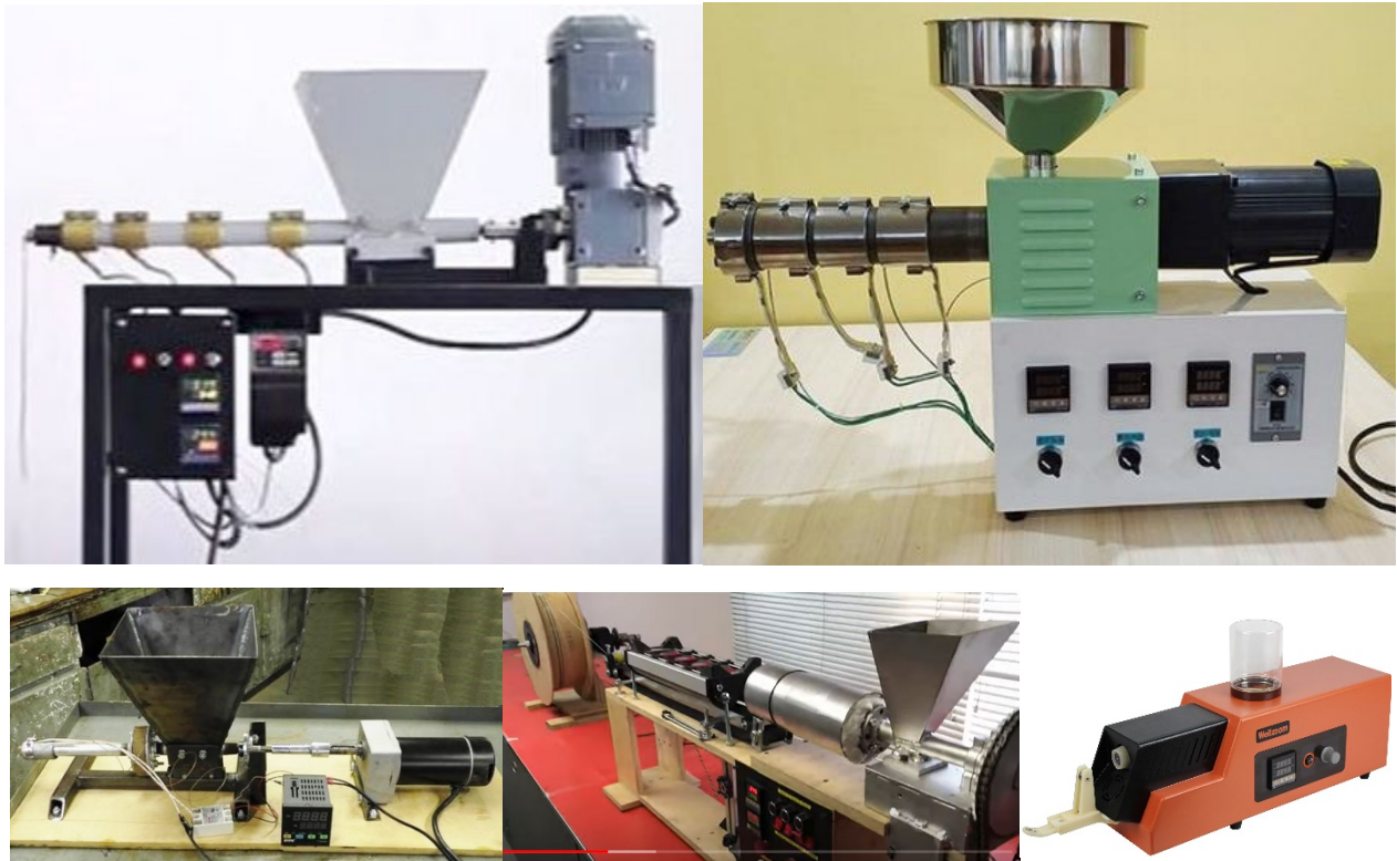
Рис. 2. Приклади компактних екструдерів (серійного та несерійного виробництва) для виготовлення філаменту
