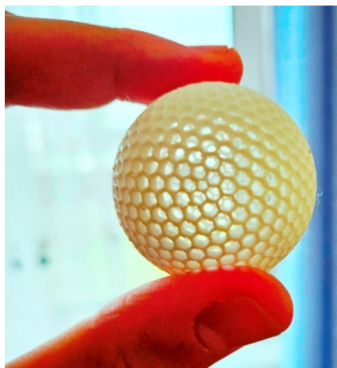
Рис. 3. Друкований м'ячик для настільного тенісу
