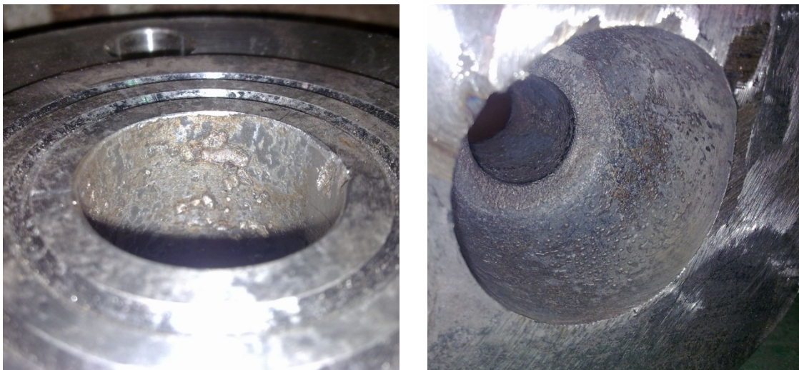
Рис. 2. Газові дефекти на внутрішній поверхні виливків
