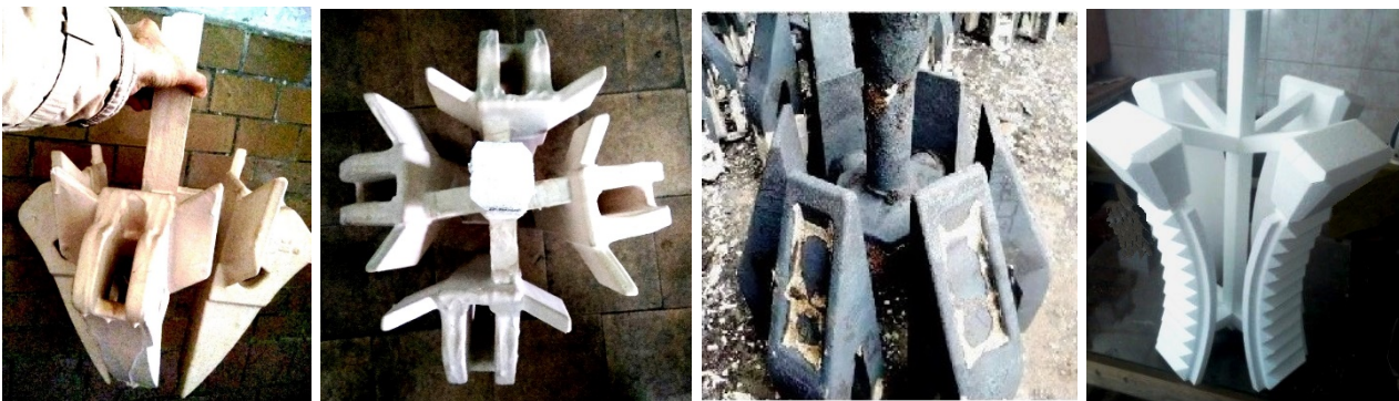
Рис. 1. Кластери (кущі) моделей та виливків: а, б – моделі коронки для зуба ковша при виді збоку і зверху; в – виливки зуба; г – моделі зубчастої деталі
