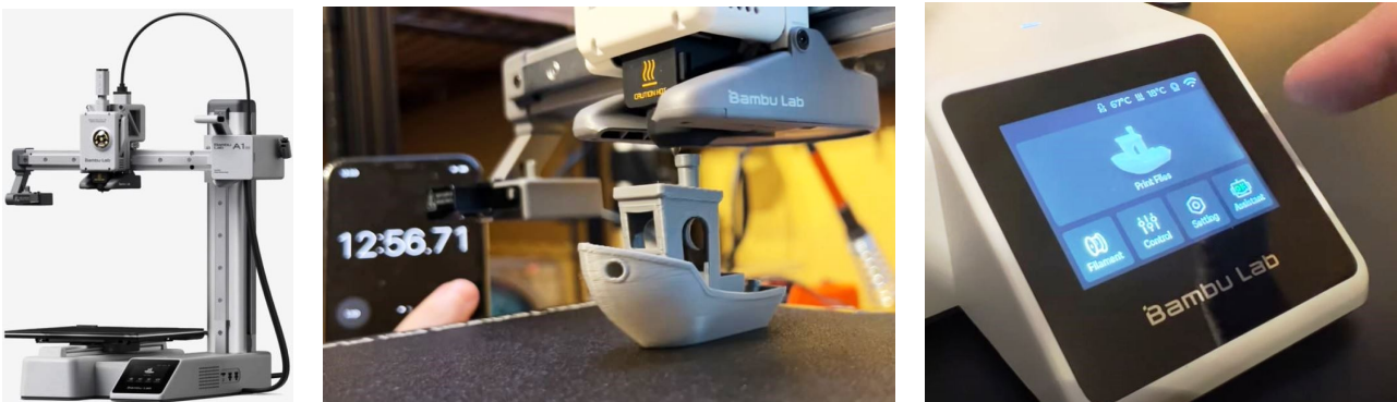
Рис. 1. Зовнішній вигляд принтера, друкування тестової моделі Benchy, вибір режимів друку на сенсорному екрані
