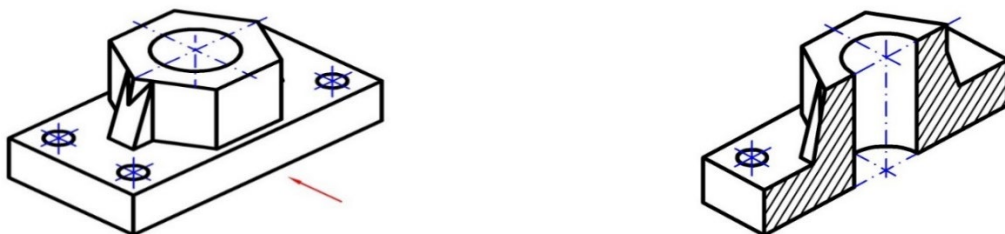
Рис. 2. Напрямок погляду для зображення виду спереду та уявне видалення частини деталі, що розташована перед фронтальною січною площиною
