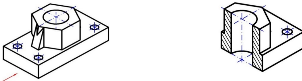
Рис. 5. Напрямок погляду для зображення виду зліва та уявне видалення частини деталі, що розташована перед профільною січною площиною
