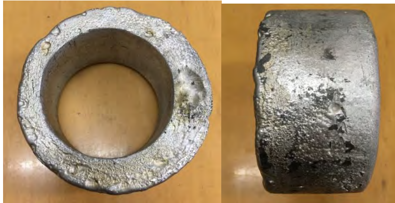
Рис. 2. Фото кільцевих проб, покритих фарбою на основі цирконію
