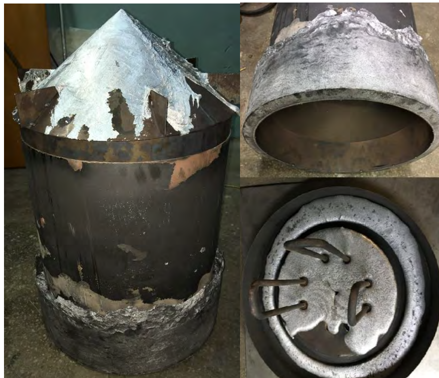
Рис. 4. Фото кокілю після заливання та до від'єднання виливка від форми
