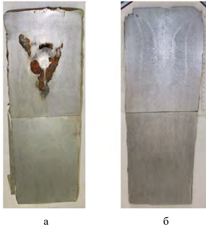
Рис. 5. Макроструктура експериментальних зливків: а – без зовнішнього впливу, б – з підігріванням та перемішуванням
