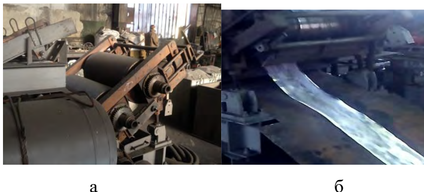
Рис. 1. Фото двовалкової ливарної машини (а) та результат лиття (б)
