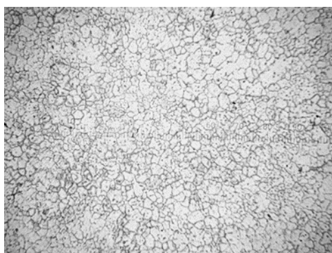
Рис. 3. Мікроструктура зразка алюмінієвого сплаву Д16, отриманого методом валкового лиття-прокатування (x100)
