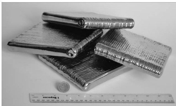
Рис. 3. Зовнішній вигляд плоских монокристалів вольфраму 170x160x20 мм
