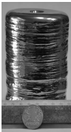
Рис. 6. Зовнішній вигляд кристалу вольфраму діаметром 85 мм
