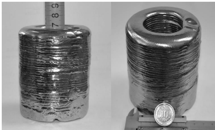
Рис. 7. Загальний вигляд монокристалу вольфраму у вигляді порожнистого тіла обертання \varnothing 85 мм
