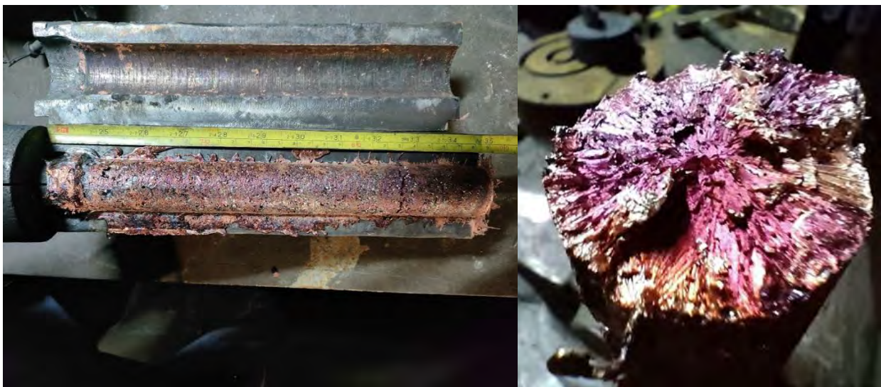
Рис. 2. Отриманий зразок сплаву Cu-Cr-Zr-V-Hf
