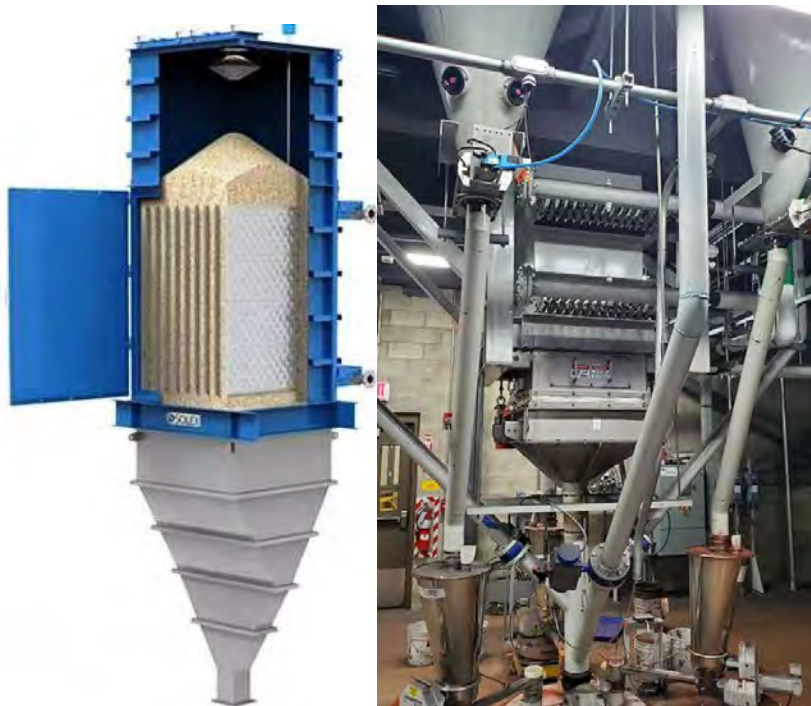
Рис. 1. Конструктивна схема та зовнішній вигляд теплообмінника
