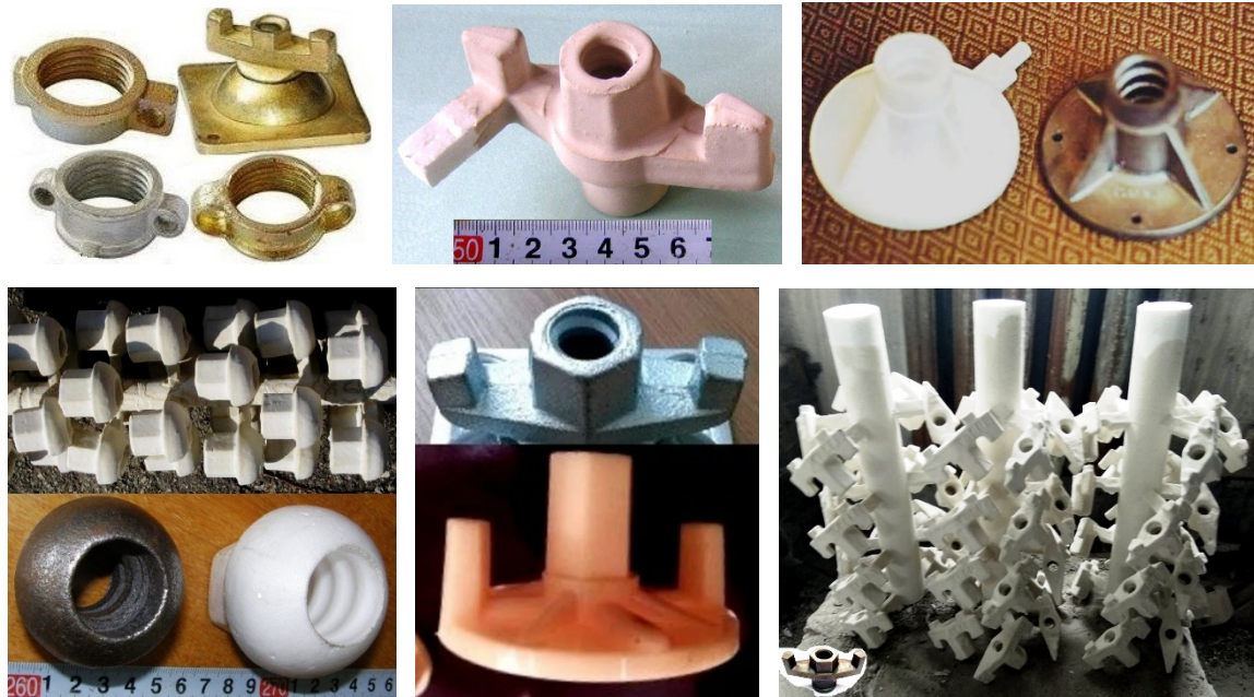
Рис. 3. Приклади металевих кріплень з литою різьбою і їх моделей з ППС
