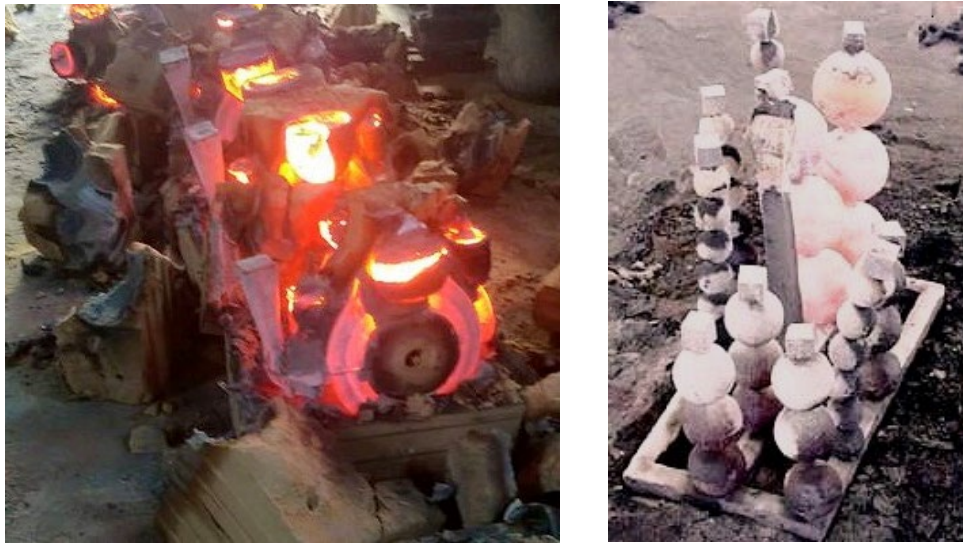
Рис. 2. Приклад видалення гарячих виливків з сирої піщано-глинястої форми та гарячих молольних куль (для млинів) з форми за ЛГМ-процесом
