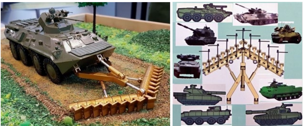
Рис. 1. Макет модульного тралу на виставці "Інтерполітех-2018" [1] та приклади бронетехніки для його застосування
