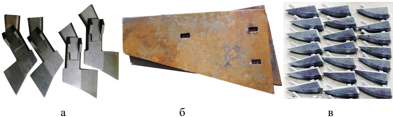
Рис. 4. Приклади виливків (а, б), що застосовують в умовах зношування, та їх пінополістирольні моделі (в) для ЛГМ
