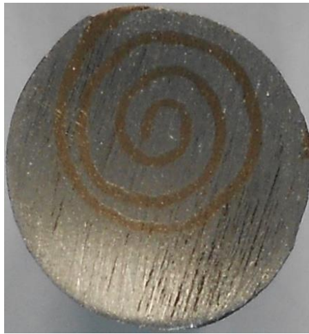
Рис. 1. Робоча поверхня зразка для випробувань на триботехнічні властивості (Ø 10 мм)
