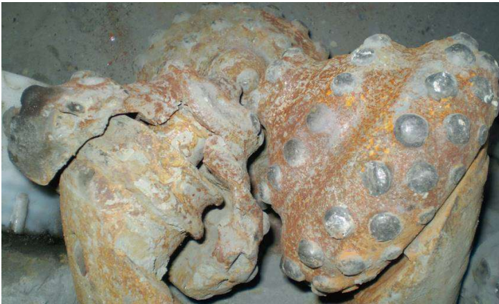
Рис. 1. Крихке руйнування тіла однієї з шарошок бурового долота 244,5 ОК-ПГВ (шарошки виготовлені зі сталі 14ХНЗМА-В)
