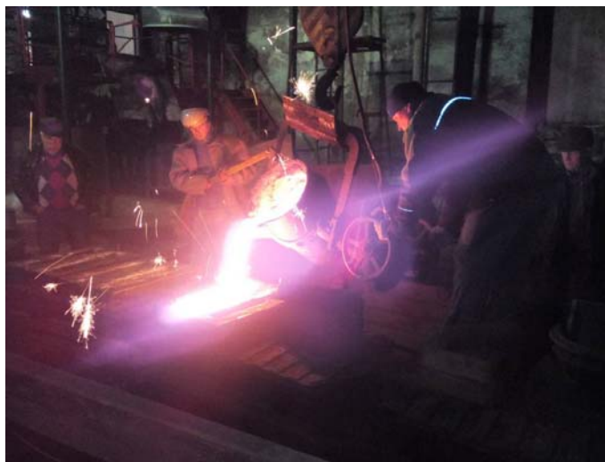
Рис. 6. Процесс заливки формы серым чугуном
