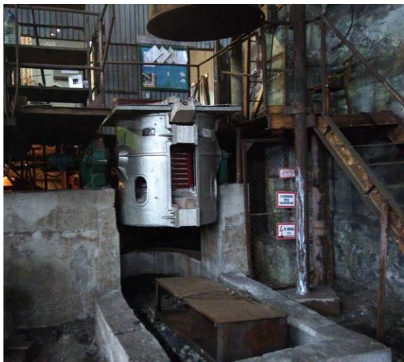
Рис. 4. Индукционная печь емкостью 1 тонна, мощностью 1000 кВт, производительностью 0,5 т/час
