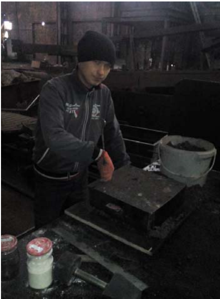
Рис. 4. Глеб Савощенко формует будущие детали зерносушилки
