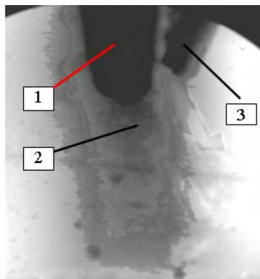
1 – кристаллизатор; 2 – кристаллы модельного вещества; 3 – термопары
