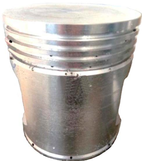
Рис. 1. Поршень із сплаву АК12М2МгН з дефектами у вигляді газової пористості
