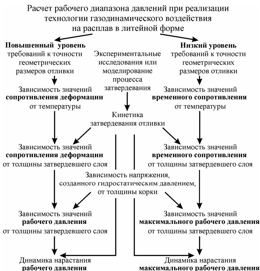
Рис. 1. Схема алгоритма расчета рабочего диапазона давлений при газодинамическом воздействии
