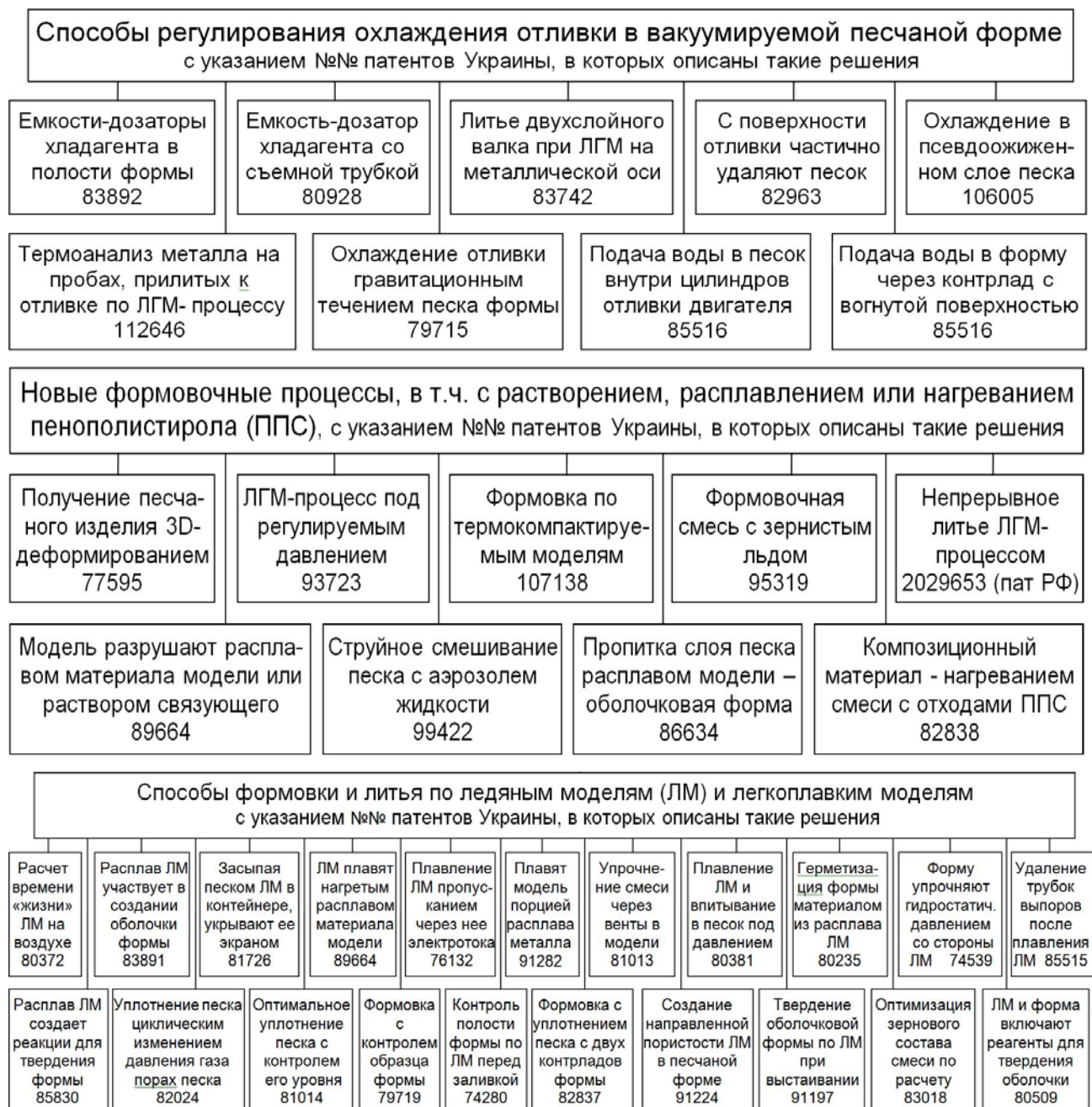
Рис. 1. Новые технические решения по технологии формы и процессам литья по разовым моделям
