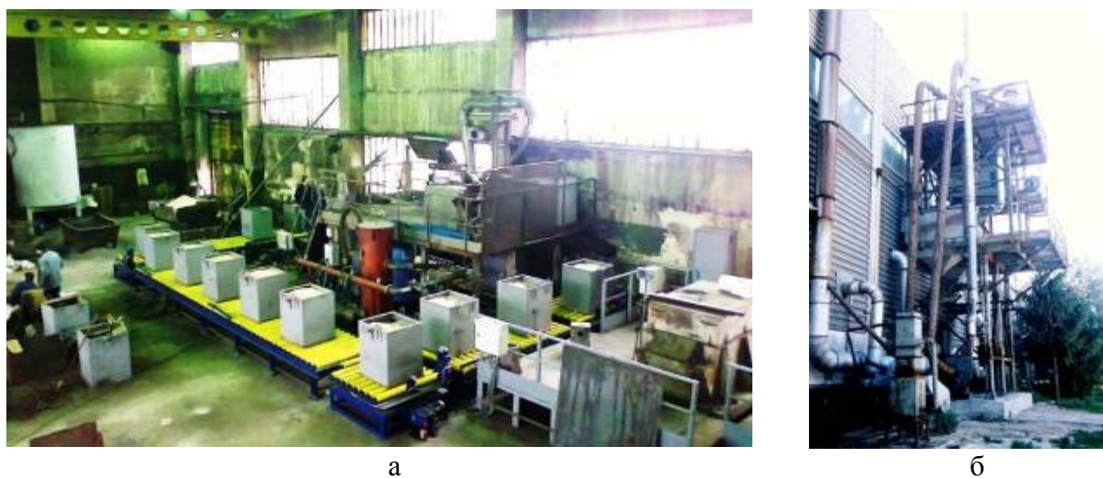
Рис. 3. Формовочно-заливочний конвейер (а) и линия регенерации песка (б)
