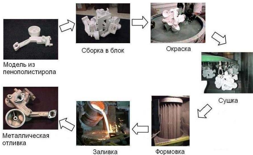
Рис. 2. Последовательность операций ЛГМ-процесса в фотографиях
