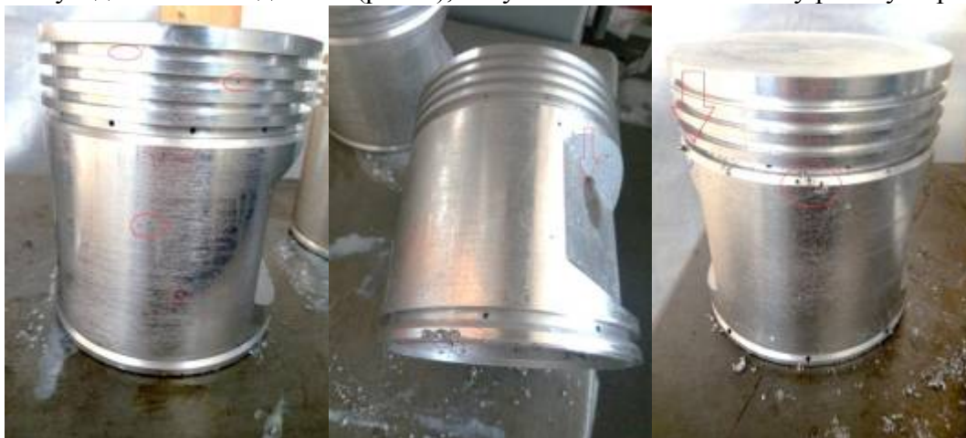
Рис.1. Дефекти у вигляді газосуадкових раковин на оброблених виливках поршнів
