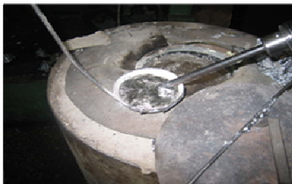
Роторная обработка дозы расплава в условиях ВАТ «ЛТАВА» (г. Полтава)
