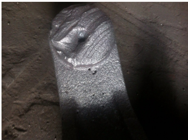
Рис. 1. Проблеми усадкового характеру у виливку «Важіль рульової тяги», пов'язані із неправильно спроектованою прес-формою
