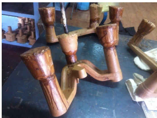
Рис. 2. Експериментальна модель виливка «Важіль рульової тяги» до БТР-ЗДА
