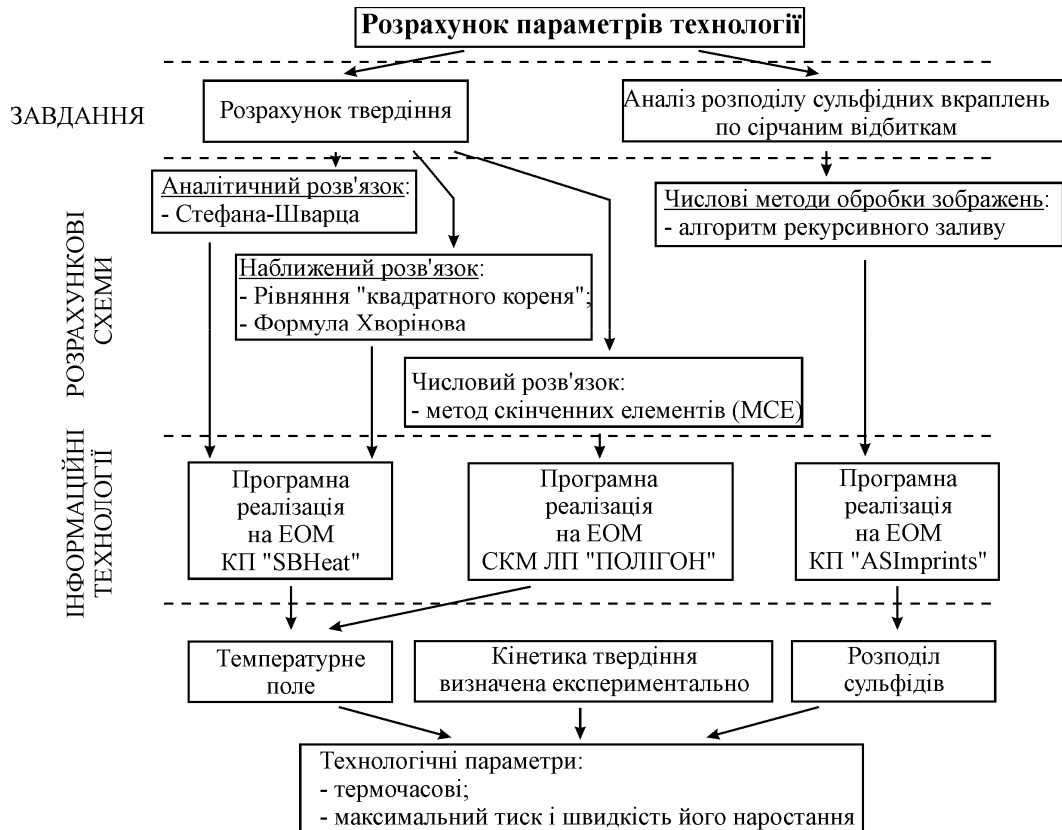
Рис. 1. Схема, яка ілюструє загальну методику визначення технологічних параметрів на прикладі сталевого виливка
