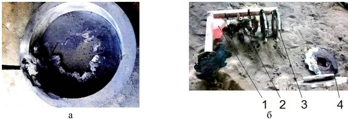
1 – след на стояке от осыпания песка; 2 – бракованные от засора отливки; 3, 4 – годные отливки
