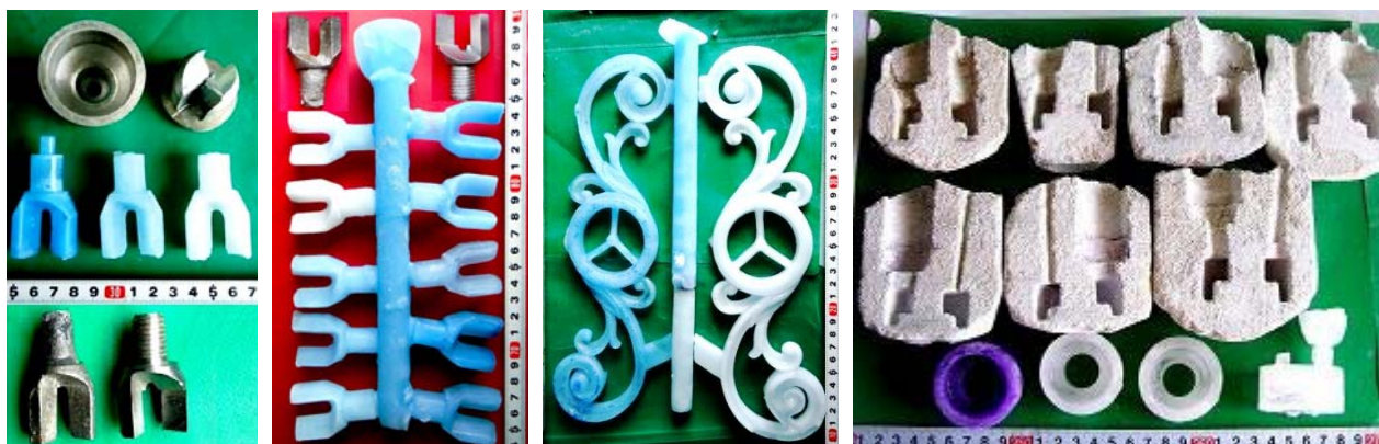
Рис. 1. Ледяные модели и полученные по ним оболочки
