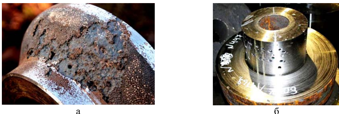
Рис. 2. Дефекты от попадания продуктов деструкции модели в поверхностные (а) или внутренние слои стенки отливки (б)
