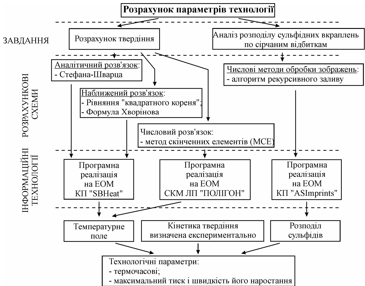
Рис. 1. Схема, що ілюструє загальну методику визначення технологічних параметрів на прикладі сталевого вилівка
