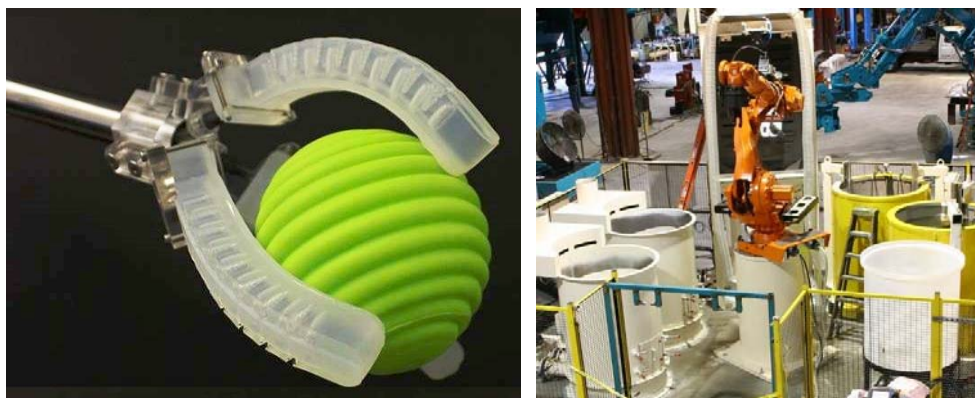
Рис. 1. Примеры мягкой руки робота и роботизированного участка изготовления песчаных оболочек по выплавляемым моделям (ЛВМ)
